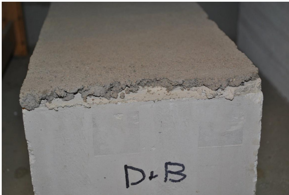
Foto 2. Putsning av prover för studium av materialkombinationer.
