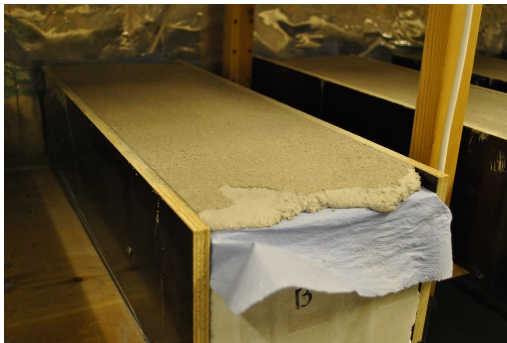
Foto 1. Putsning av prover för bestämning av enskilda materialegenskaper.
