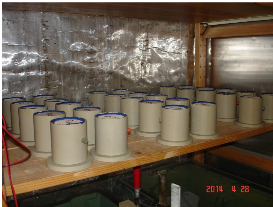
Foto 6. Provuppställning vid bestämning av fukttransportkoefficienter i det hygroskopiska området.
