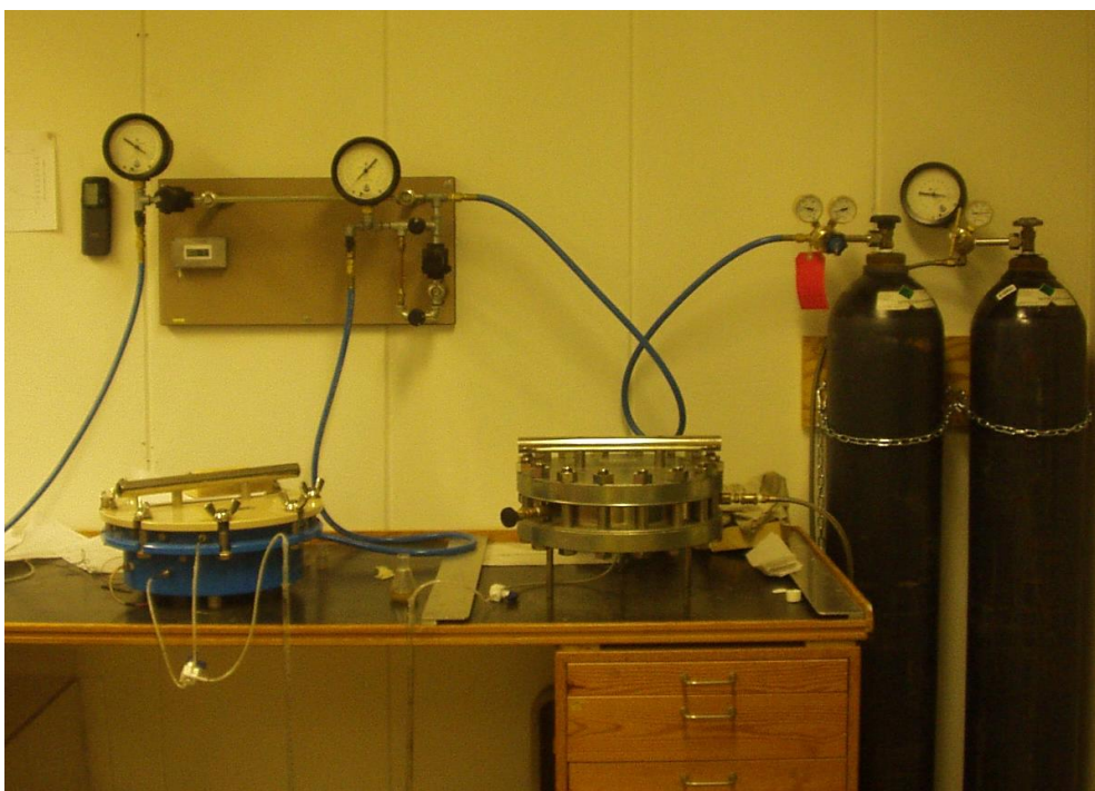
Foto 5. Två "pressure plate" kammare avsedda för maximala trycken 1.5 MPa respektive 10 MPa anslutna till tryckregulatorer och gasflaskor.
